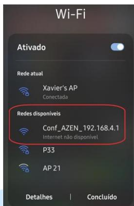
9. Assim que o dispositivo se conectar à rede SSID Conf\_AZEN\_192.168.4.1, abra um navegador de internet e digite o endereço: 192.168.4.1.
