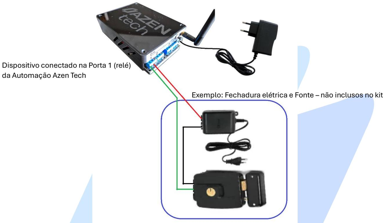
4. As conexões nas portas devem ser de forma individual, e um dispositivo para cada porta. Ligue o fio fase do dispositivo sempre na conexão central da porta, e a primeira conexão ao segundo fio – retorno ao dispositivo.
